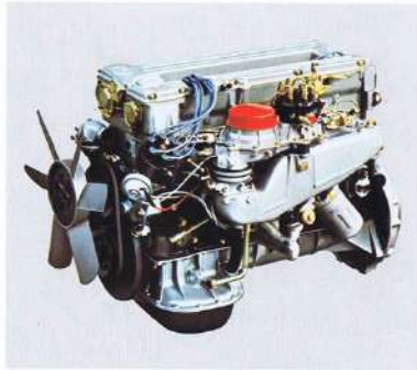
Motor des 280 GE: 6-Zylinder-Einspritzmotor mit 110 kW (150 PS).
