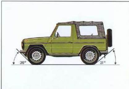
Radstand und Aufbauabmessungen ergeben große Überhangwinkel.
