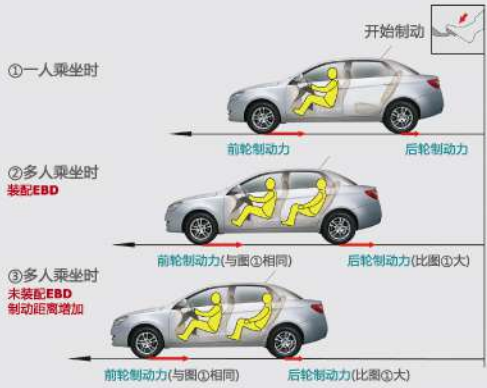
EBD(电子制动力分配系统)示意图
