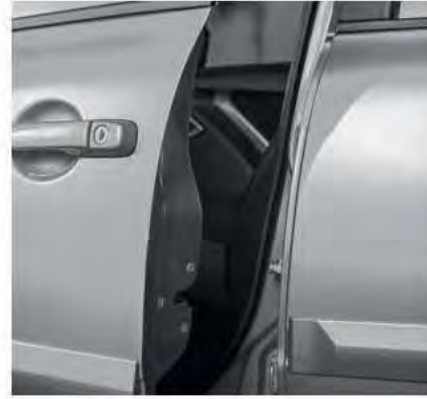
تتوقف الأبواب بالتدرج بالقصور الذاتي - ولن تفعل ذلك بنفسك في كل مرة ليكون ثابتاً في الموضع المطلوب
