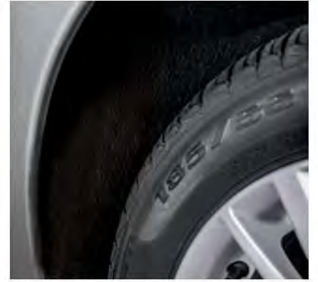
أغطية عجلات ناعمة لعزل صوتي أفضل: من أجل "امتصاص" الضوضاء التي تنتجها الرمال والحصى
